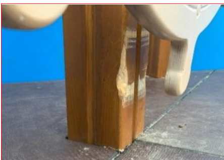
Недопустимы: отщепы, сколы, трещины, заусенцы
