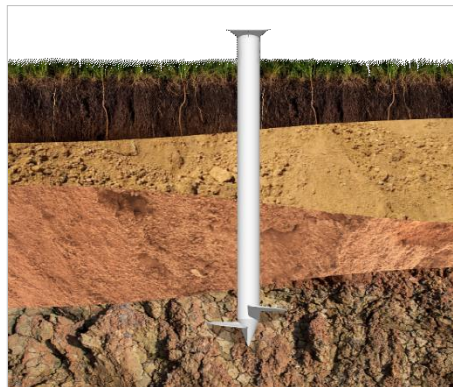
Пример установки свай для настилов
