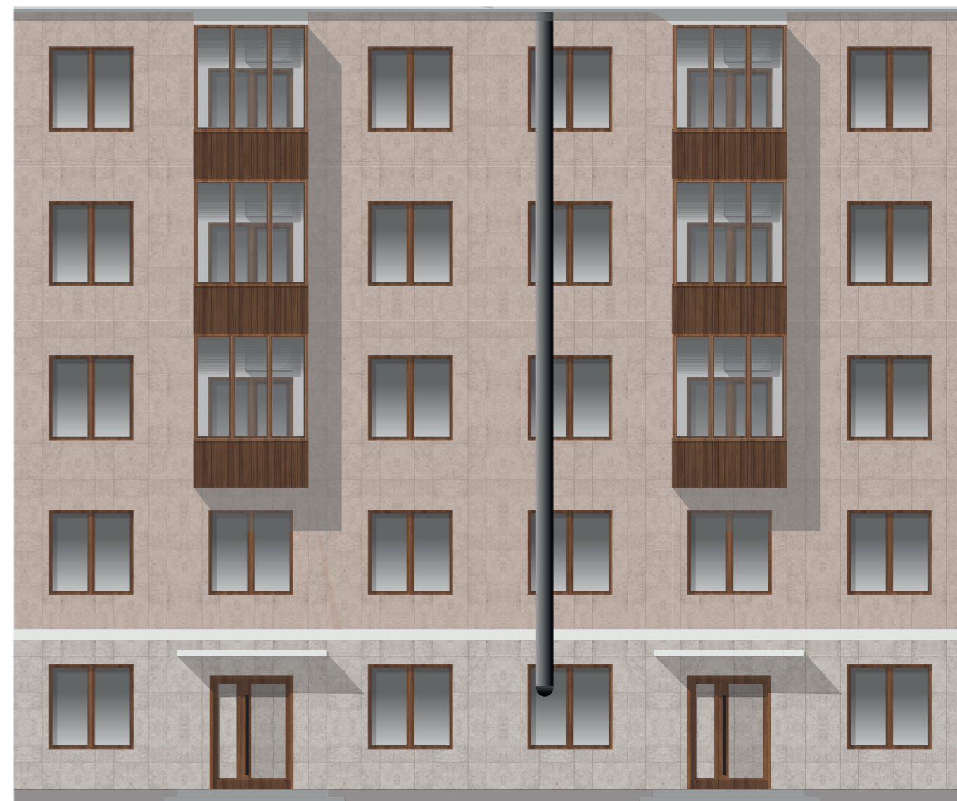
ПЛОХО. Вентиляционная труба перекрывает окна и выделяется на фоне фасада
