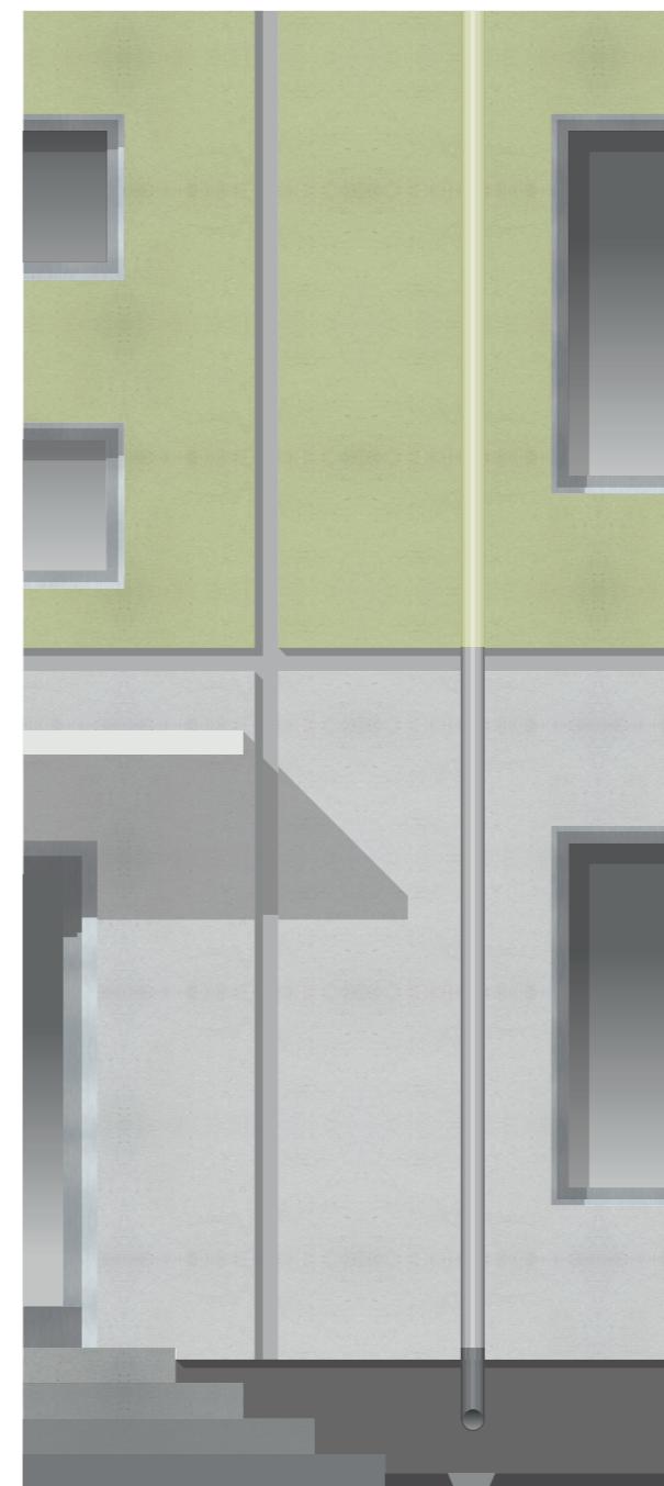
ХОРОШО. Водосточная труба имеет отвод в водоприемный лоток
