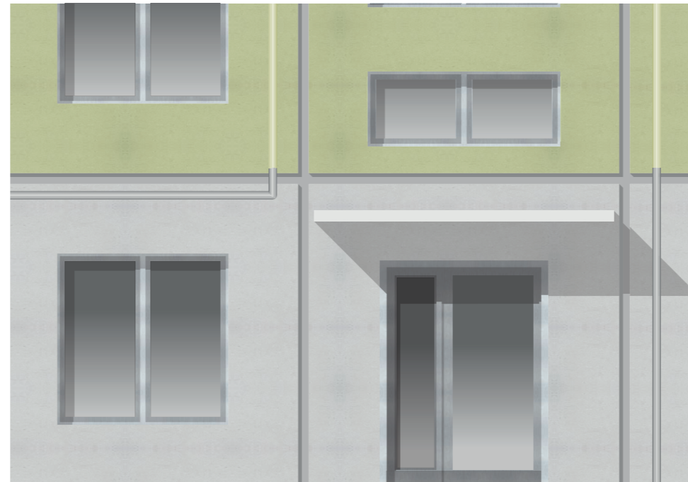
ХОРОШО. Инженерные провода проложены в коробах, выкрашенных в цвет фасада
