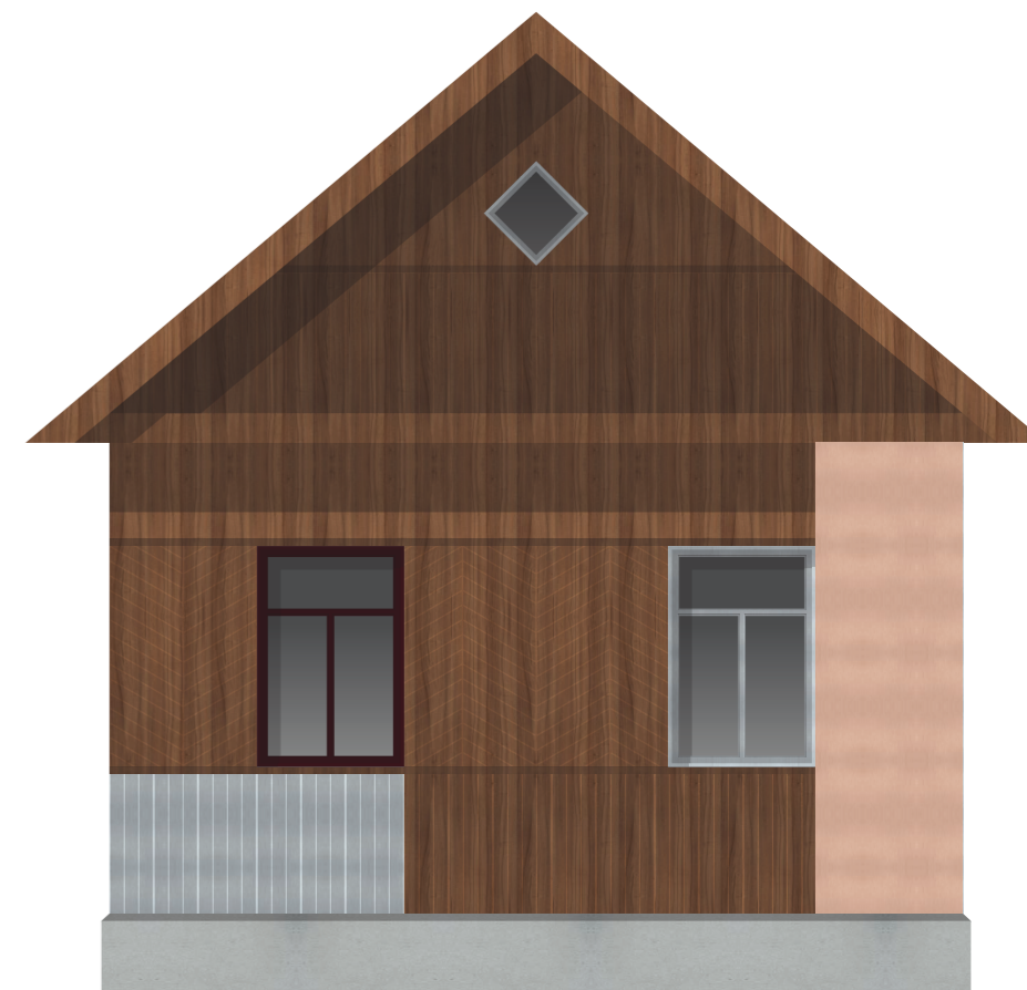
ПЛОХО. Деревянное здание потеряло исторический вид из-за фрагментарной отделки чужеродным материалом
