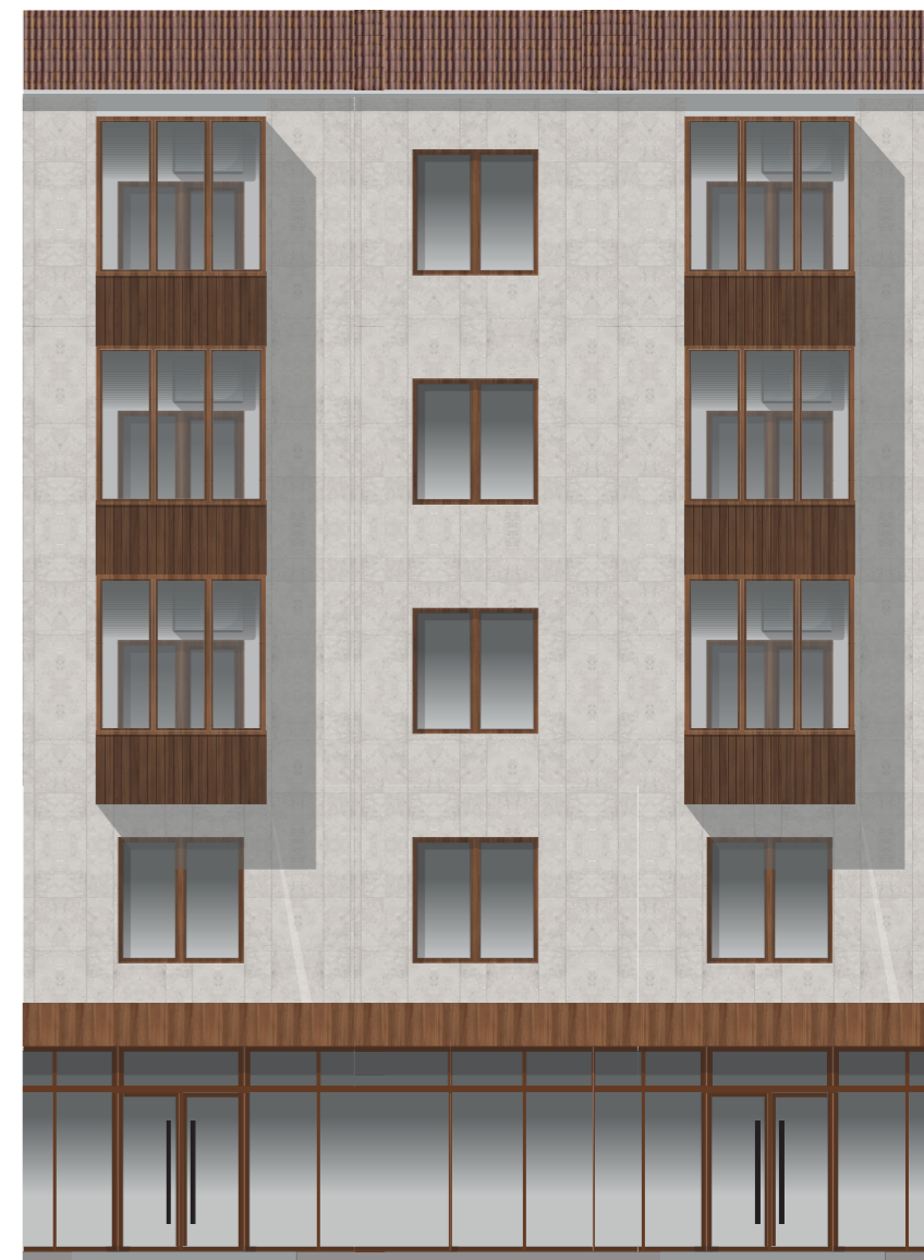
ХОРОШО. Кондиционеры размещены внутри балконов
