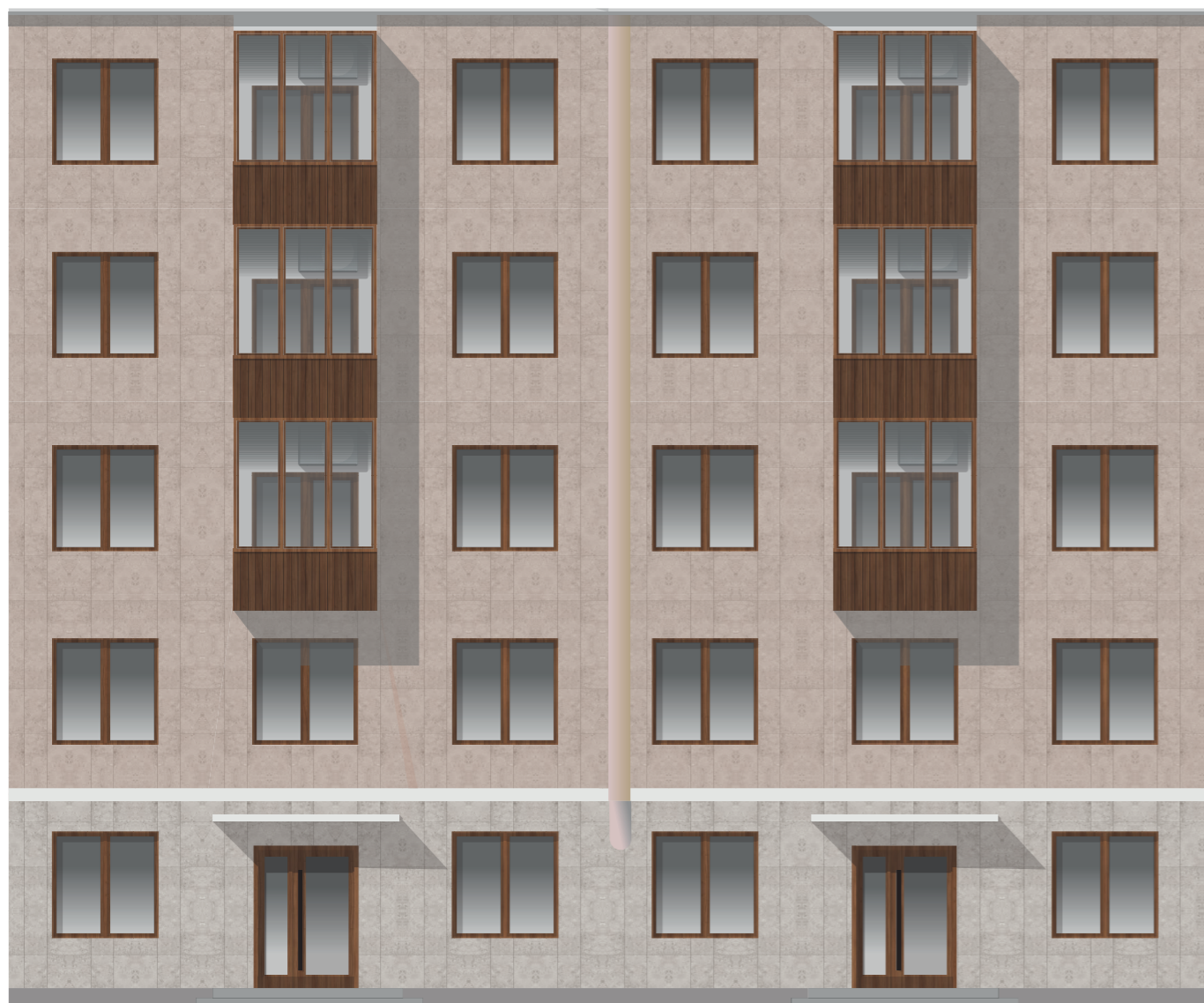
ХОРОШО. Вентиляционная труба не перекрывает окна и окрашена в цвет фасада
