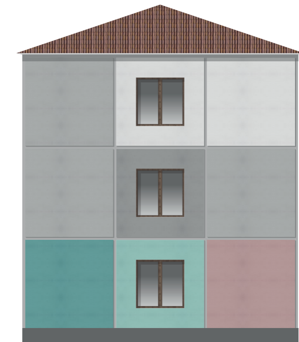
ПЛОХО. Торцы имеют фрагментарную отделку
