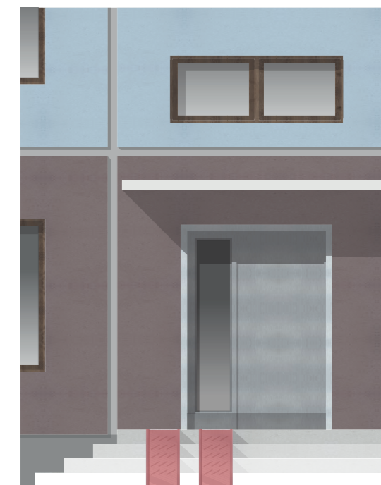
ПЛОХО. Применение аппарелей вместо пандусов не допускается
