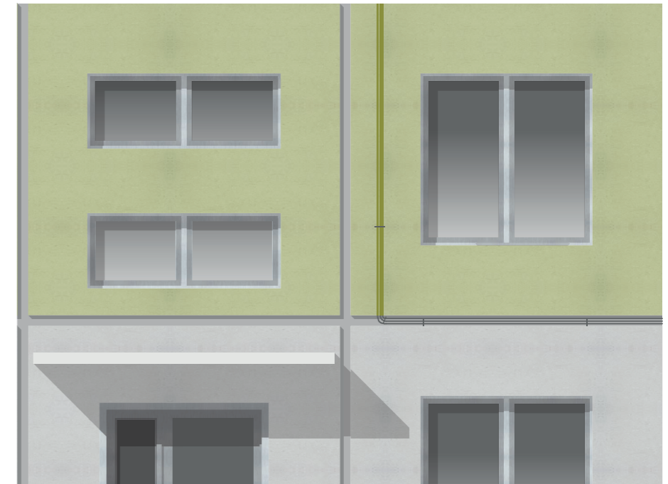
ХОРОШО. Инженерные провода упорядочены и выкрашены в цвет фасада
