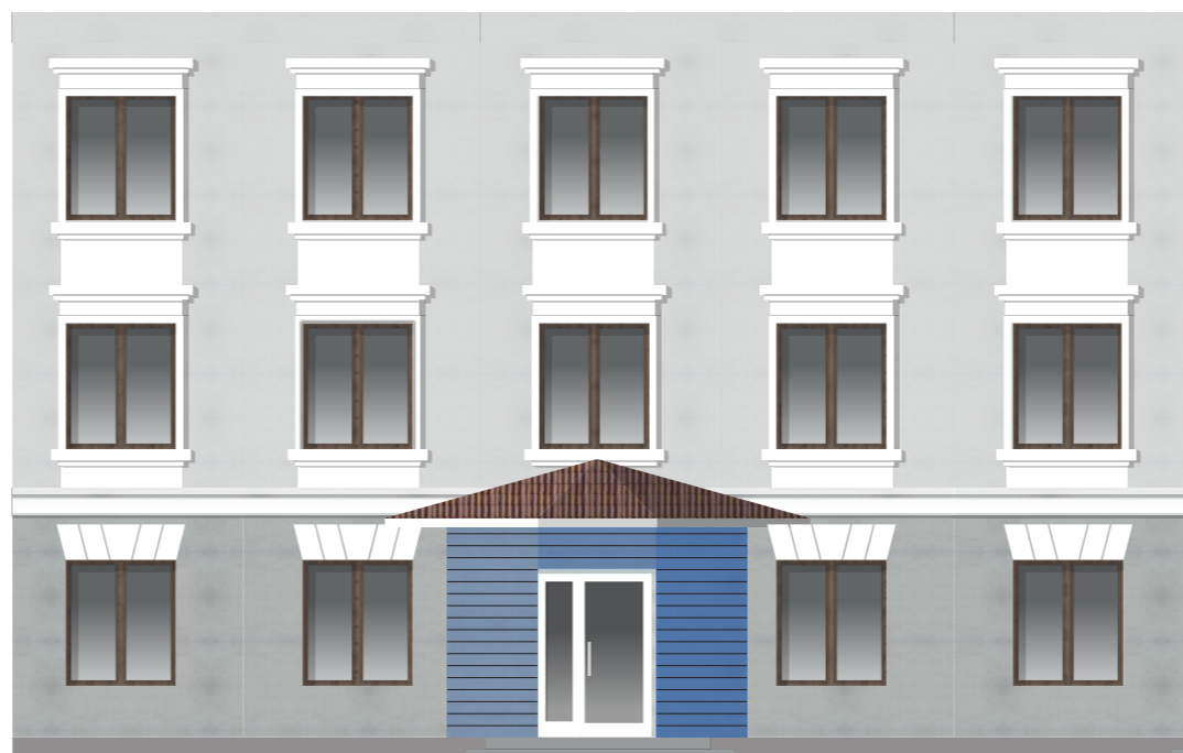
ПЛОХО. Пристройка не вписывается в архитектуру здания
