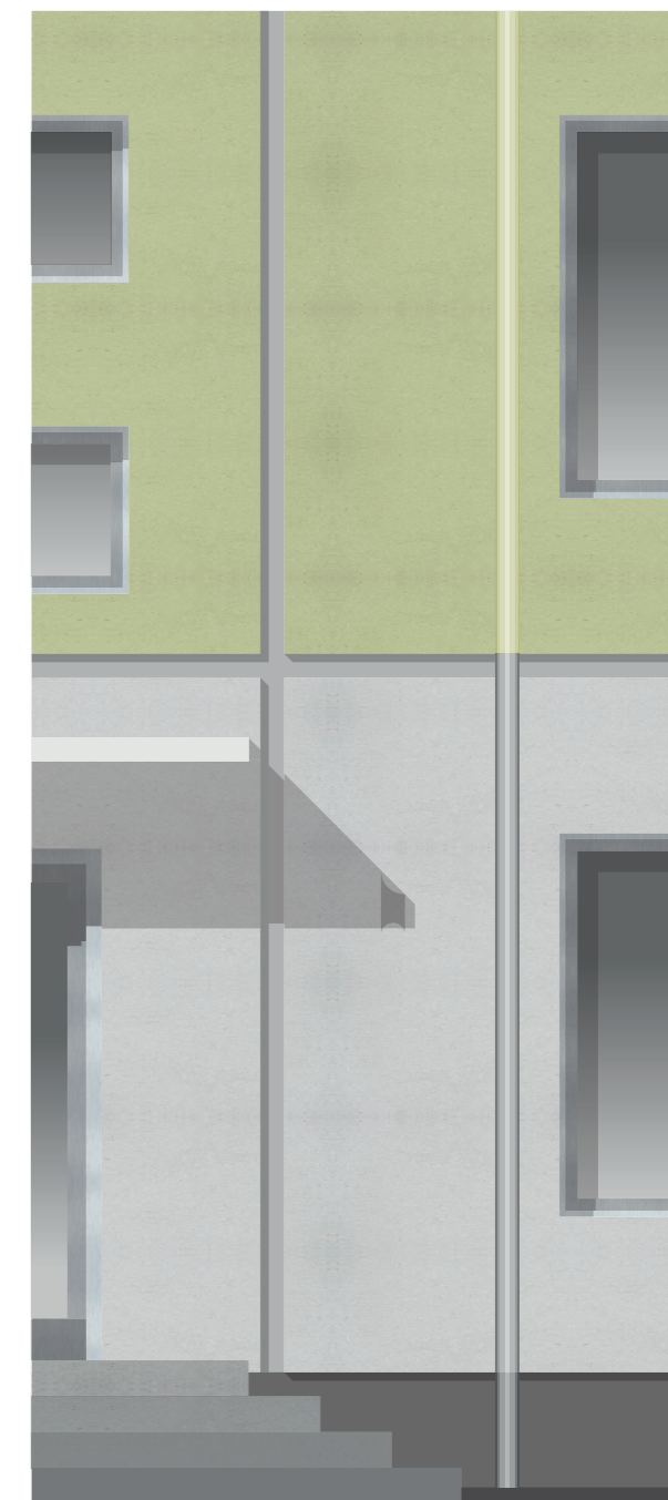
ХОРОШО. Водосточная труба соединена с ливневой канализацией
