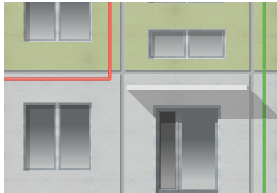
ПЛОХО. Инженерные провода проложены в коробах, контрастирующих с цветом фасада
