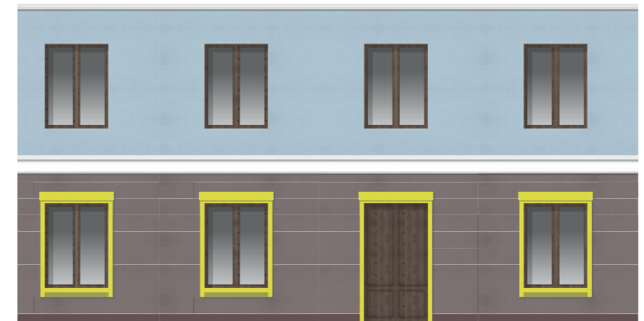
ПЛОХО. Окраска декоративных деталей с нарушением ПЦР
