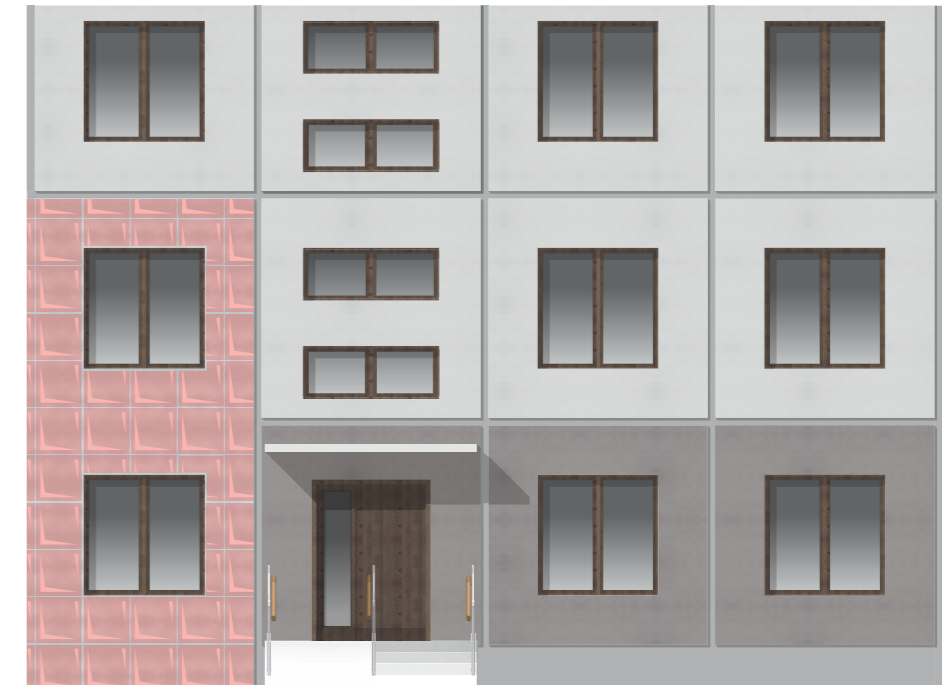
ПЛОХО. Фасад имеет фрагментарную отделку разными материалами
