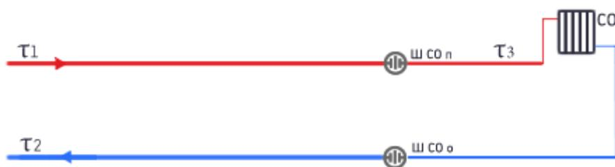
**Рисунок 19 – Схема с непосредственным присоединением системы отопления**
