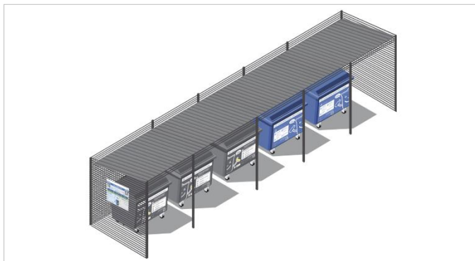
Пример ограждения с калитками и крыши контейнерной площадки из дерева и металла
