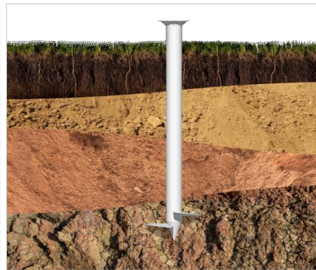
Пример установки свай для настилов
