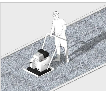
Трамбовка ручным виброкатком
