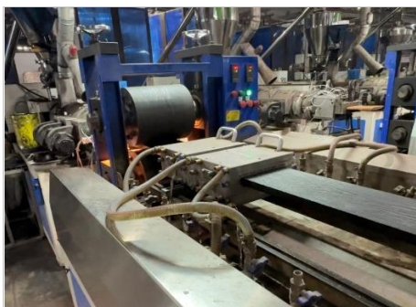
Производство ДПК из смеси полимера и древесной муки
