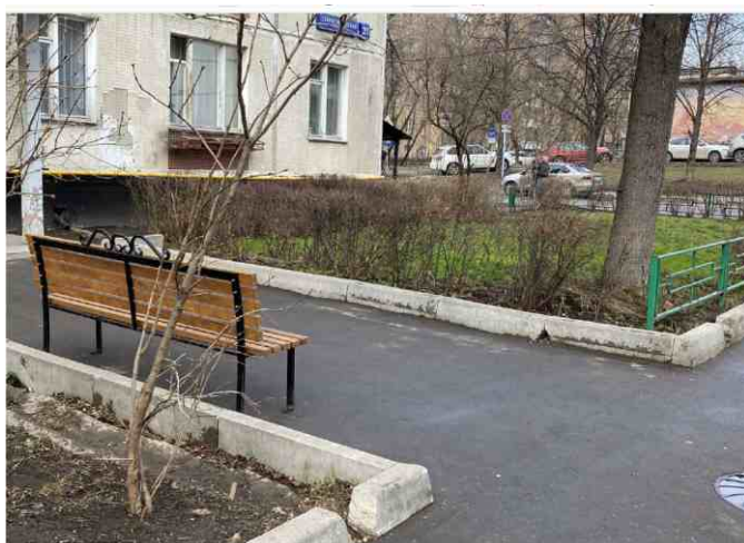
ПЛОХО. Входная зона в жилой дом и пешеходная зона не выделены мощением, покрытие из асфальтобетона
