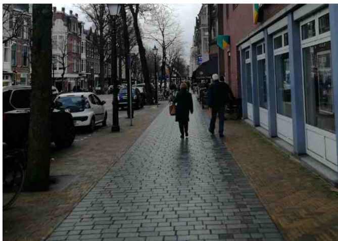
ХОРОШО. Буферная зона и прифасадная зоны выделены другим цветом и рисунком мощения
