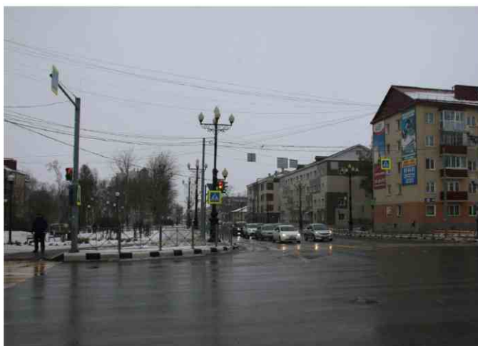
ПЛОХО. Излишнее количество светильников, воздушная прокладка проводов
