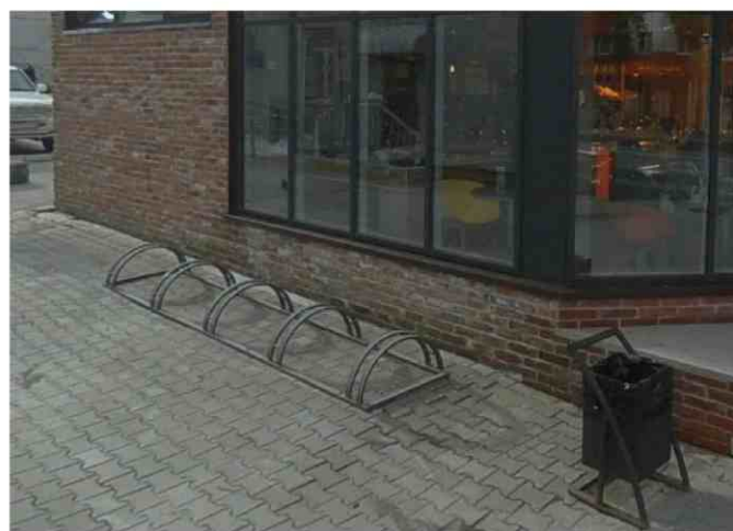
ПЛОХО. Велопарковка предусматривает крепление только колеса велосипеда: это небезопасно
