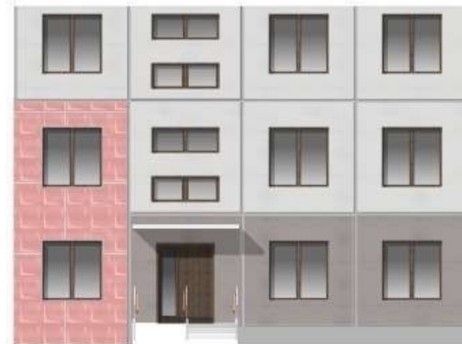
ПЛОХО. Фасад имеет фрагментарную отделку разными материалами
