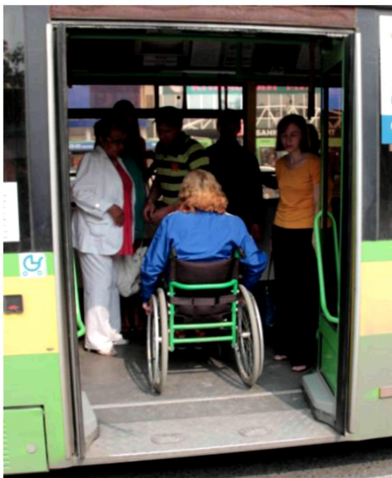
Рисунок 3.16.13 – Отсутствие площадки для представителя МГН в подвижном составе
