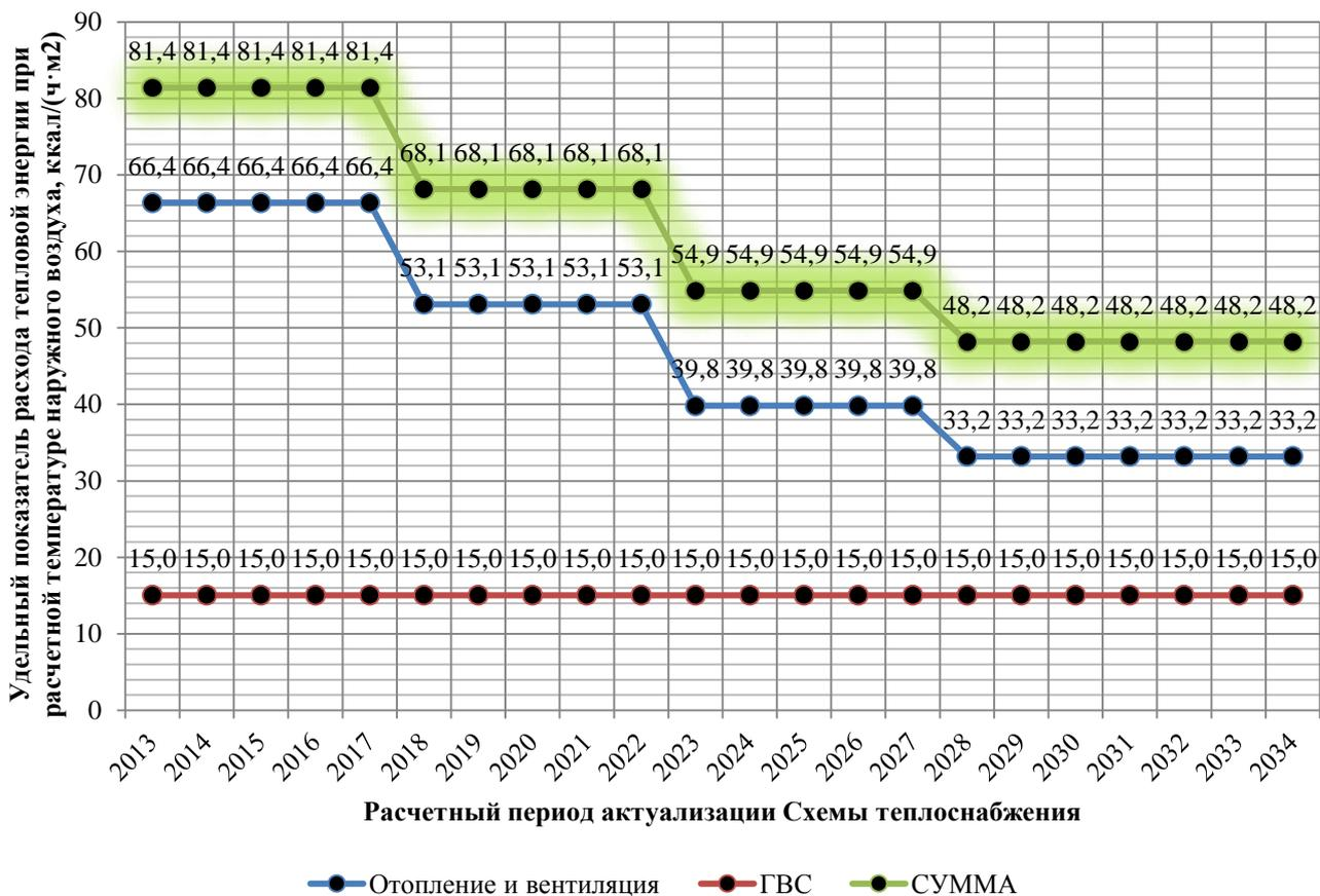
Рисунок 1-2. Изменение нормируемого удельного расхода тепловой энергии на отопление, вентиляцию и ГВС на примере 5-этажного общественного здания
