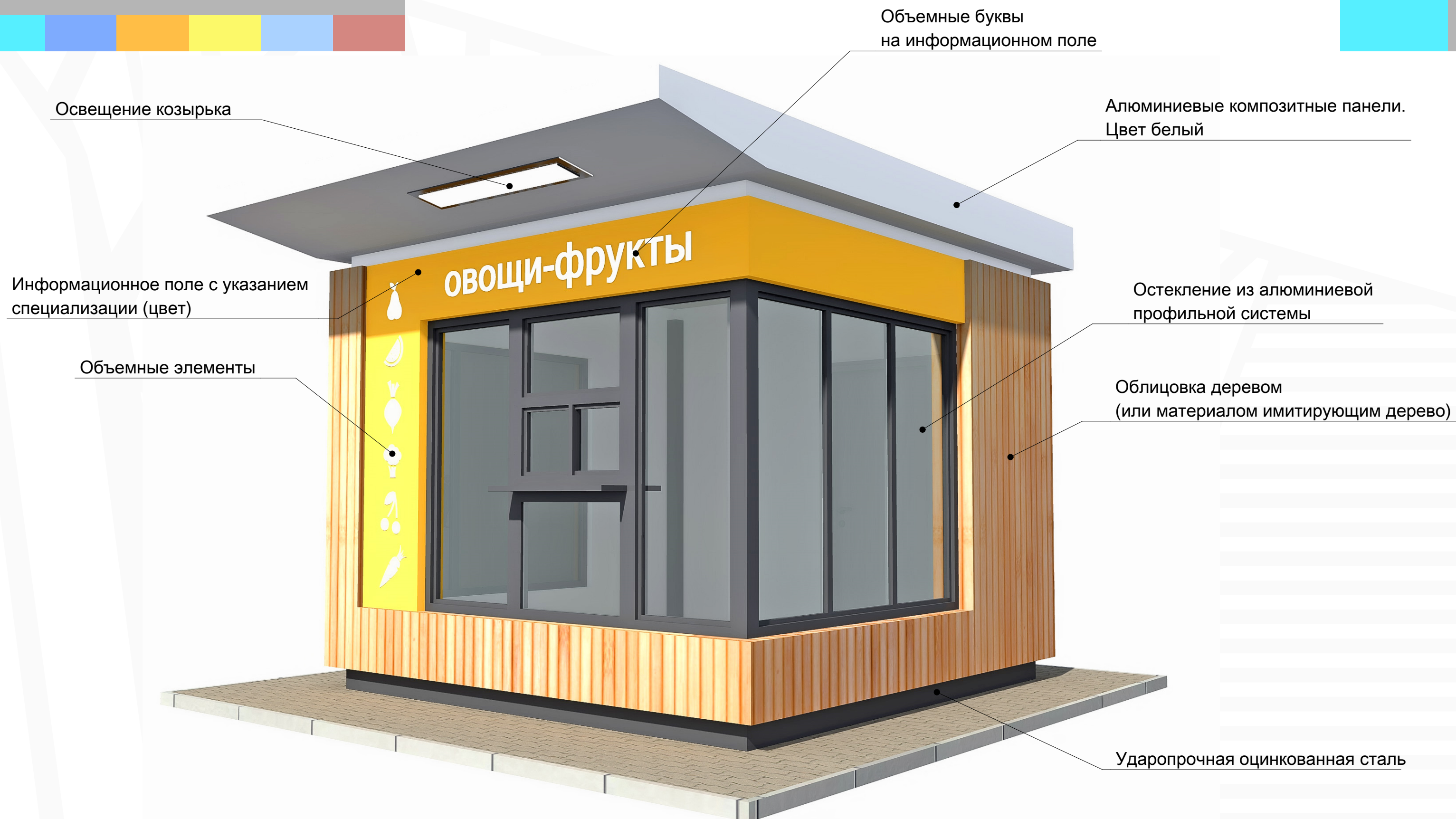
Внешний вид. Вариант с облицовкой деревом (или материалом имитирующим дерево) для киоска «Овощи-фрукты». Размер в плане 3 x 3 м
