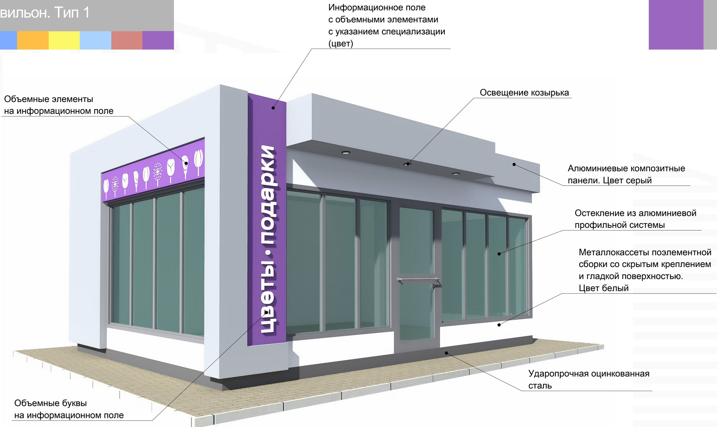
Внешний вид. Вариант с облицовкой композитными панелями для павильона «Цветы-подарки». Размер в плане 6 x 4 м
