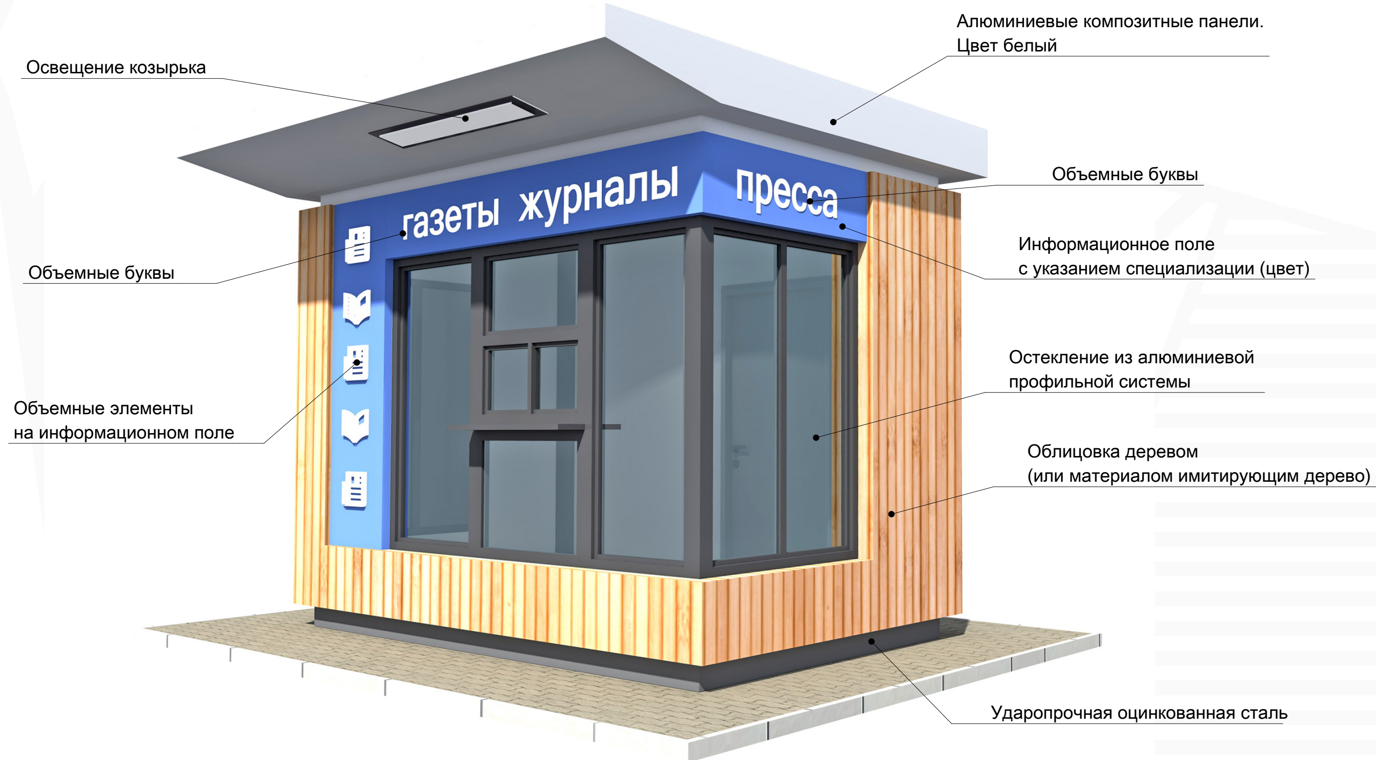
Внешний вид. Вариант с облицовкой деревом (или материалом имитирующим дерево) для киоска «Пресса». Размер в плане 3 x 2 м
